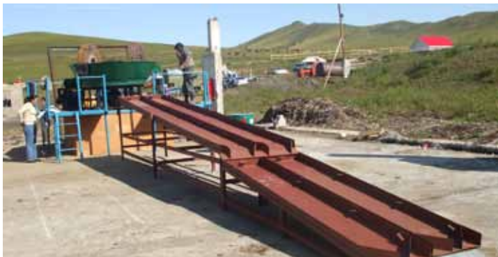
Зураг 6. Үндсэн ба хяналтын шлюз Шлюзийн техникийн үзүүлэлтийг Хүснэгт 3-т үзүүлэв.
