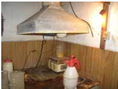
Зураг 10. Баяжмалыг азотын сулруулсан хүчлээр үйлчилж байгаа нь.
