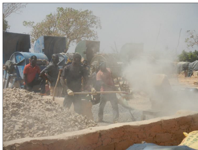
Зураг 11. Бичил уурхайн үндсэн ордын орчинд тоосжилтонд өртөх аюул түгээмэл байдаг. (Зургийг: АБУЗ)
